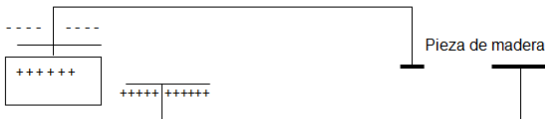
Fig. 1. Condensador con pieza de madera como dieléctrico.
