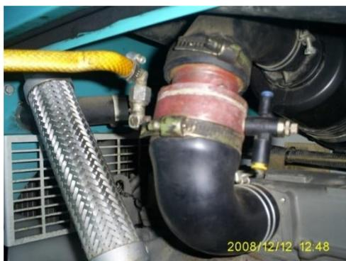
**Figura 1.** Dispositivo para la alimentación de la mezcla aire-biogás a presión (Fuente de los autores)
