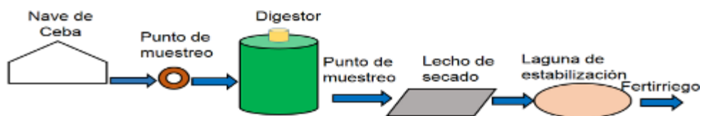
Fig.1. Planta de Tratamiento Anaerobio
