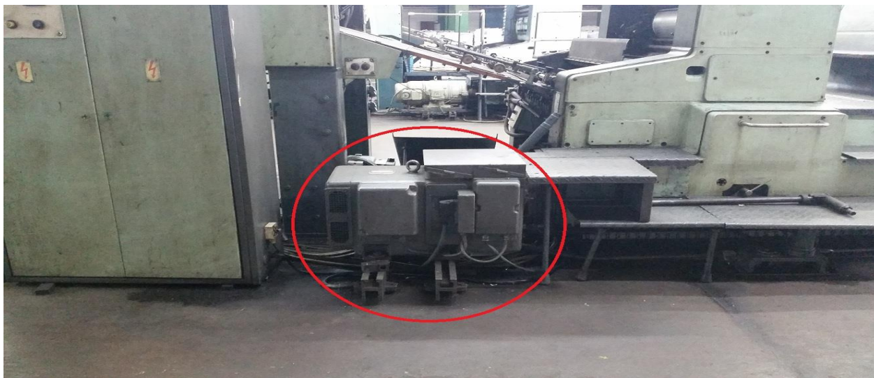
Fig. 2 Máquina impresora planeta y su accionamiento eléctrico original
